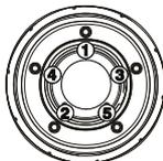
4. Aperte os parafusos em estágios. Seguindo a sequência recomendada, aperte cada parafuso conforme o torque da roda de 163 Nm (120 lb-ft).
