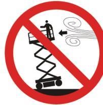
**NÃO** levante a plataforma ou a opere elevada em condições de vento ou rajadas de vento que excedam os limites especificados na [Seção 7.5](#).
