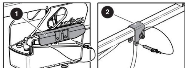
11. Posicione o **console de controle da plataforma** no piso da plataforma.
