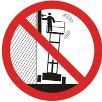
**NÃO** ultrapasse a força lateral máxima especificada na etiqueta de capacidade da plataforma quando em elevação (consulte a [Seção 7.5](#)).
