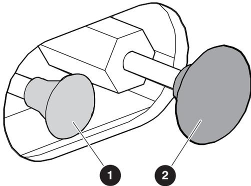
Figura 10 Distribuidor de deslocamento (freio a disco)
