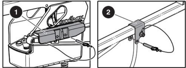
5. Posicione o **console de controle da plataforma** no piso da plataforma.
