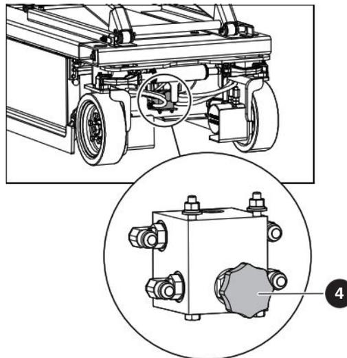
Figura 04 Válvula de livre rodagem (SJ3215 e SJ3219)
