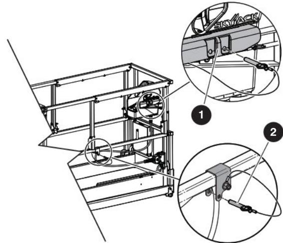
17. Coloque o **console de controle de dupla altura** no suporte superior.
