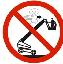
**NÃO** levante a plataforma ou a opere elevada em condições de vento ou rajadas de vento que excedam os limites especificados na [Seção 7.7](#).
