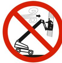
**NÃO** aumente a área da superfície da plataforma ou transporte grandes itens na área de superfície quando exposto ao vento. O aumento da área exposta ao vento diminuirá a estabilidade da MEWP.
