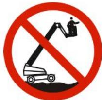
**NÃO** conduza a máquina elevada em uma superfície instável ou irregular.
