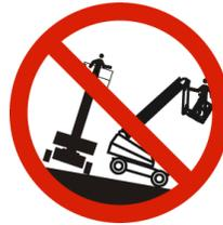
**NÃO** eleve ou conduza a máquina elevada em terreno inclinado. O deslocamento com a máquina elevada só deve ser feito sobre uma superfície firme e nivelada.
