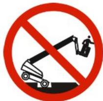
**NÃO** dirija com a plataforma elevada na proximidade de depressões ou buracos de qualquer tipo, docas de carga, detritos, declives acentuados ou superfícies que possam afetar a estabilidade da MEWP.
