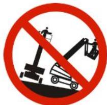
**NÃO** aumente nem diminua graus que sejam diferentes das inclinações máximas listadas na *Seção 7.4*. As inclinações ascendentes ou descendentes só devem ser realizadas quando totalmente abaixadas.
