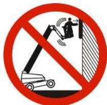
**NÃO** ultrapasse a força lateral máxima especificada na etiqueta de capacidade da plataforma quando em elevação (consulte a *Seção 7.7*).
