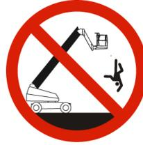
Evite quedas da plataforma. Mantenha sempre os pés firmes no piso da plataforma quando estiver trabalhando nela. Não suba no rodapé, trilho médio ou trilho superior. Não use pranchas, escadas ou quaisquer outros dispositivos sobre a plataforma para atingir altura ou alcance adicional.
